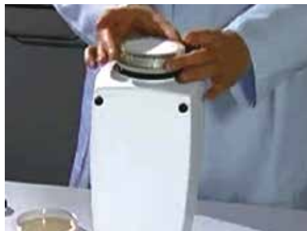
1.2 采样结束后，取下采样头保护环
