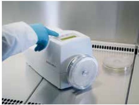
2 设置采样体积和采样速度，最大速度为 125L/min.
