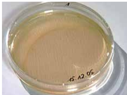
1.5 培养时，凝胶膜会融化并将微生物转移至培养基中，培养后读数。
