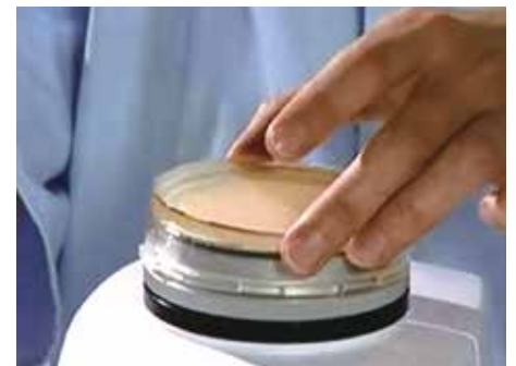
1.3 使用标准平皿倒扣粘贴凝胶膜
