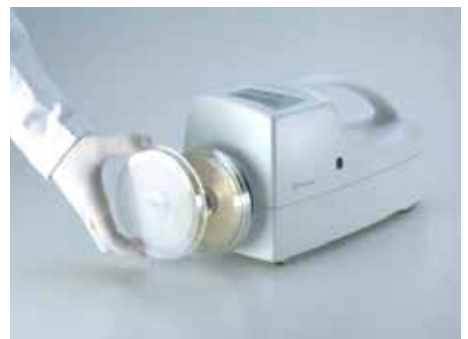
3 采样结束后，取下采样头
